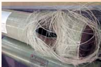
Рис.3. Разрыв металлопластикового и композитного баллонов.
