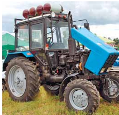
Рис.5. Верхнее расположение баллонов под компримированный природный газ неэффективно с точки зрения рациональной и безопасной эксплуатации.
