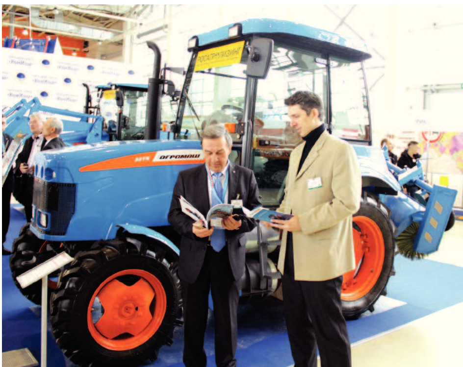
Газомоторный АГРОМАШ 50ТК МЕТАН со щеточным оборудованием.
