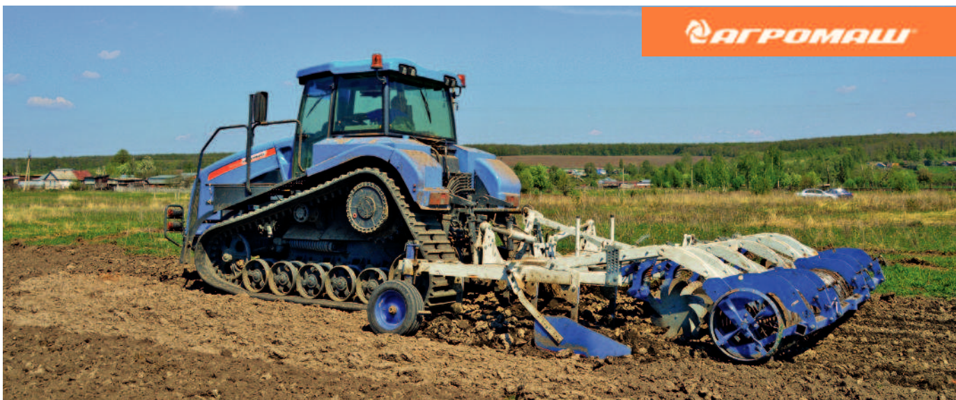
АГРОМАШ-Руслан, агрегатированный культиватором АГРОМАШ КСУ-500Г, в поле.
