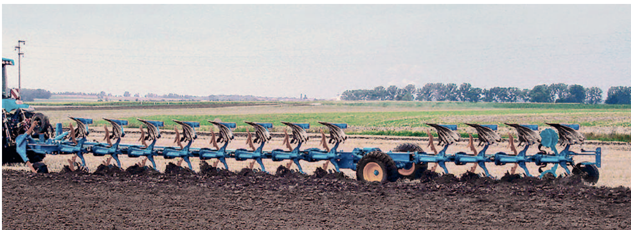
Полунавесной оборотный плуг АГРОМАШ ППУ.
