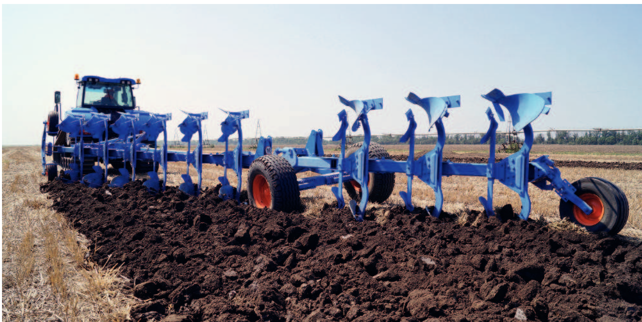
Полунавесной оборотный плуг АГРОМАШ ППО 6 + 3 в работе.
