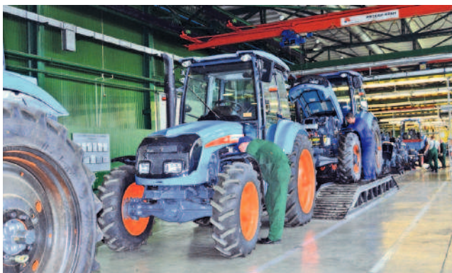
Сборочная линия тракторов АГРОМАШ 85ТК.
