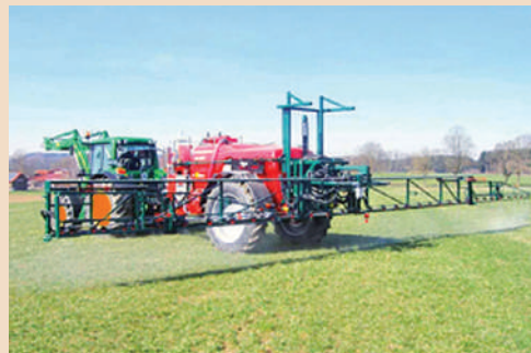
FH 903 – универсальность. Ширина – 21 м, 24 м, 27 м, 30 м.
