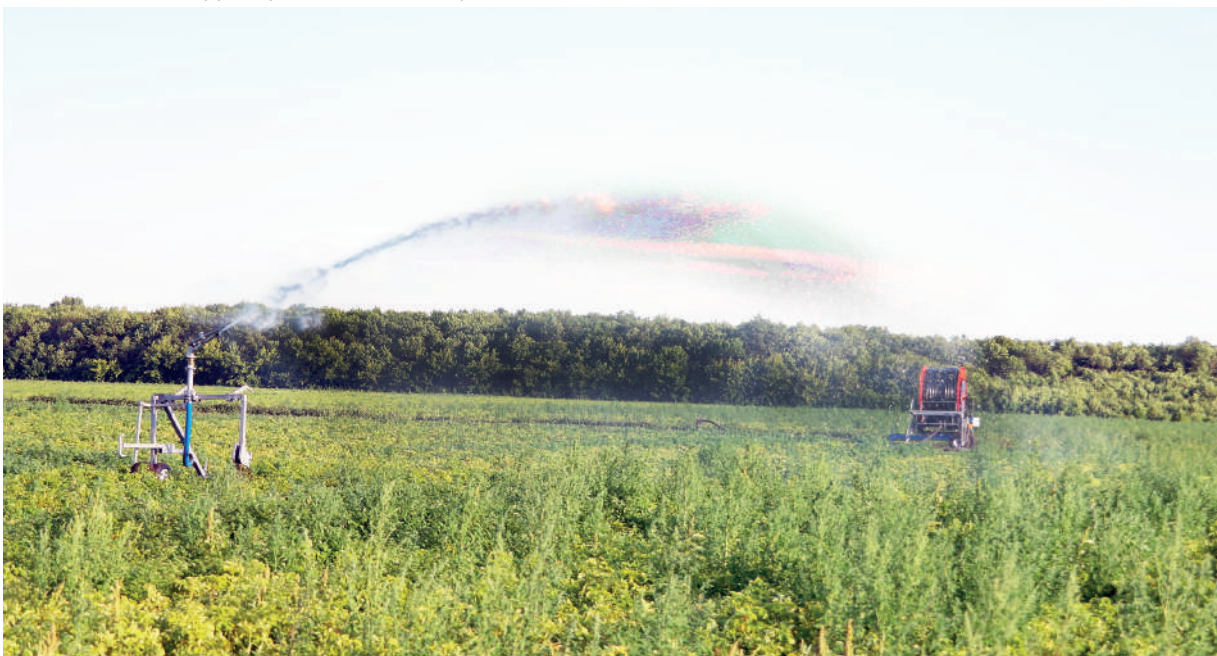
Искусственный дождь АГРОМАШ-Ниагары на испытательном поле.
